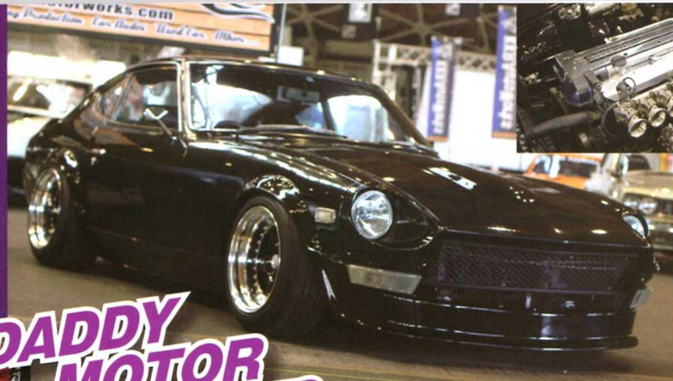
全体を黒でまとめ、バンパーレス、極太の引っぱりタイヤでシブキメた S30Z。搭載されるエンジンはL型ではなく、トヨタの 2JZ の6連スロットル化されたエンジンが搭載される
